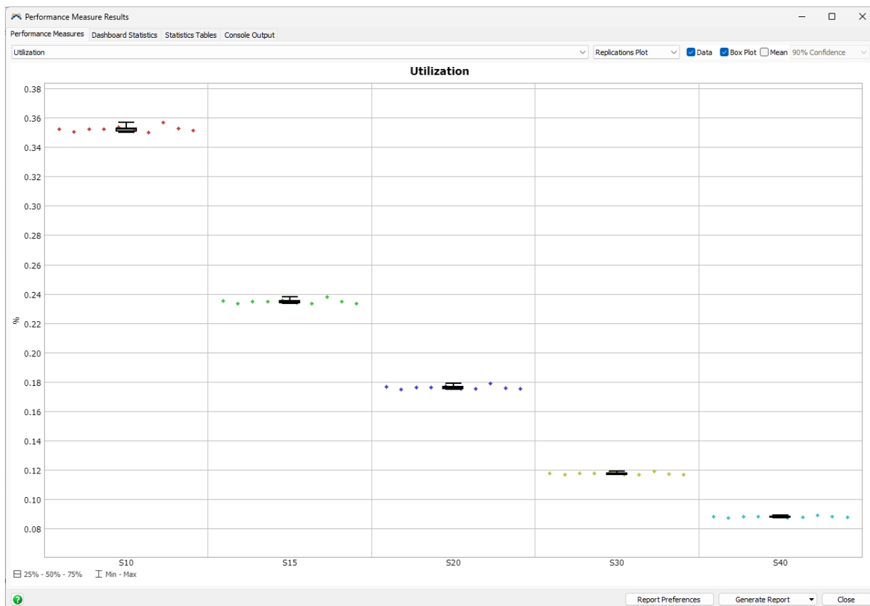
Slika 1: Simulacija izkoriščenosti polnilnic ob različnem času (vir: B. Rupnik, Strokovno svetovanje pri izdelavi digitalnega dvojčka DigiEIProm 1.2 november 2023)
