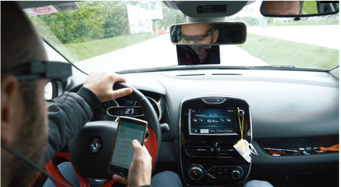
Slika 1: Slika prikazuje potek opravljanja raziskave, konkretno nalogo pisanja SMS sporočila na mobilnem telefonu. Vidna je tudi uporabljena oprema, udeleženec nosi očala za sledenje pogledu Tobii Pro Glasses 2.
