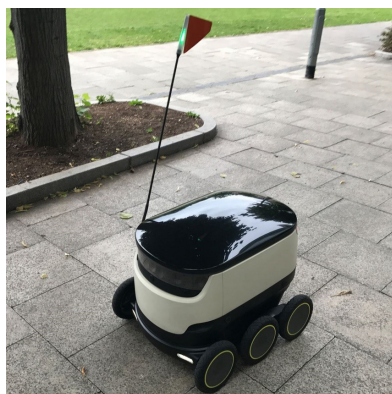
Avtonomni robot, ki dostavlja pripravljeno hrano na dom ali delovno mesto. Vir: https://www.theverge.com/2017/7/25/16024470/starship-technologies-robot-delivery-just-eat
