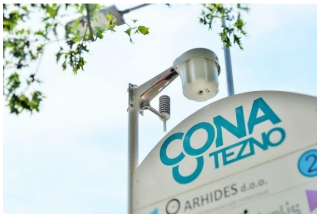
Slika 3: Senzor za merjenje temperature, vlage in zračnega tlaka (vir: Arhiv cona Tezno, 2019)
